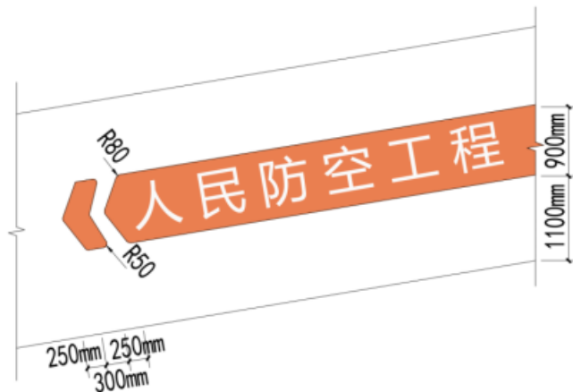
图 2 非机动车坡道侧墙标识样式示例
